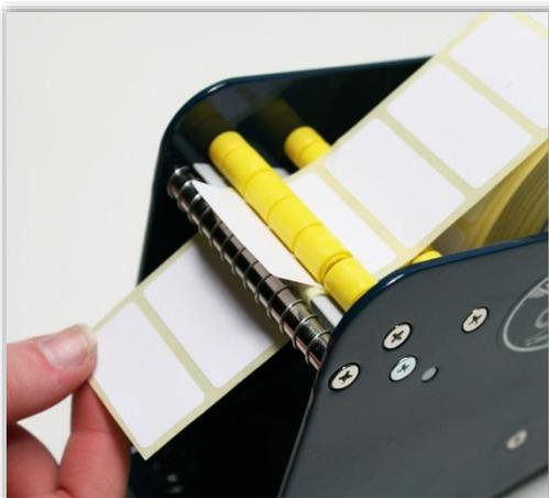
Ziehen Sie bei Bedarf am Ende der Etikettenrolle **unterhalb der Walzen** und Ihr Etikett wird automatisch vom Trägermaterial der Etikettenrolle getrennt.
